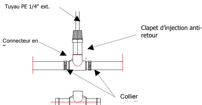
\* Il est conseillé d'effectuer l'installation avec un connecteur en T en plastique.
