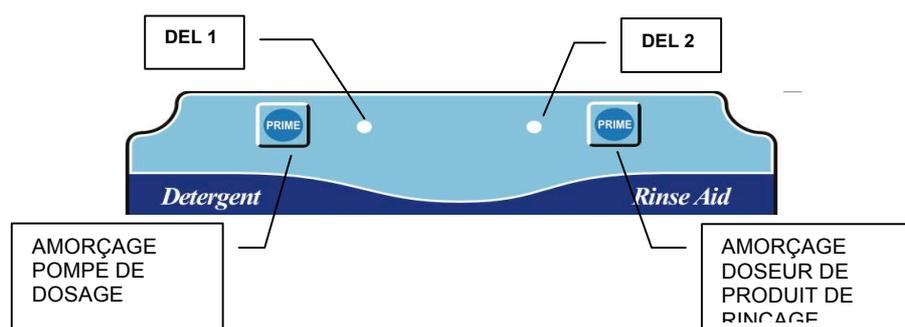
Pour amorcer la pompe à détergent, appuyer sur la touche **PRIME** à gauche, et pour amorcer la pompe à produit de rinçage, appuyer sur la touche **PRIME** à droite. Dès que l'on relâche les touches, le système repasse à la condition précédente.
